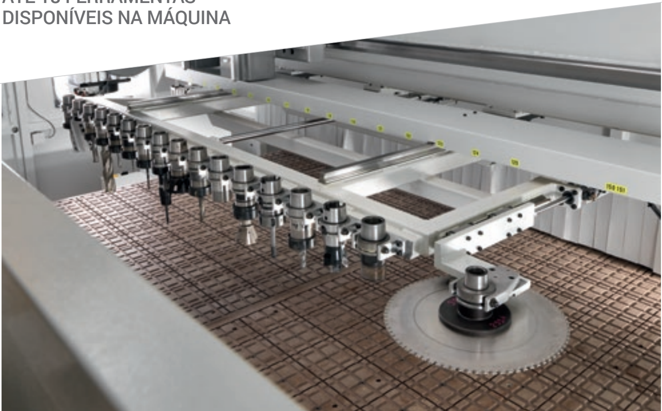
Depósito de ferramentas linear de 17 posições para uma troca rápida de ferramenta.
