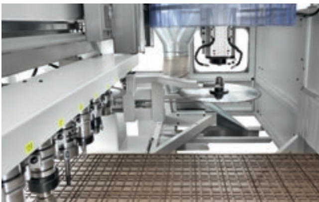
Depósito de ferramentas linear de 17 posições para uma troca rápida de ferramenta.
