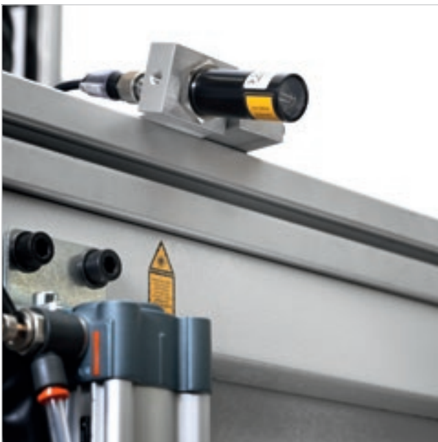
Sistema de alinhamento do painel por laser de linha na ponte móvel.
