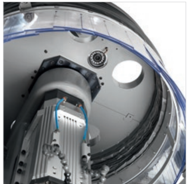
Sistema de leitura de posição com câmera para centralizar painéis grandes por meio de um ciclo de roto-translação do programa de usinagem.
